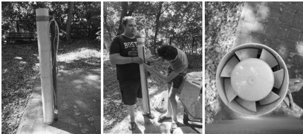
Рис. 3.12. Експериментальне дослідження аеродинамічного опору щільного шару гравію
