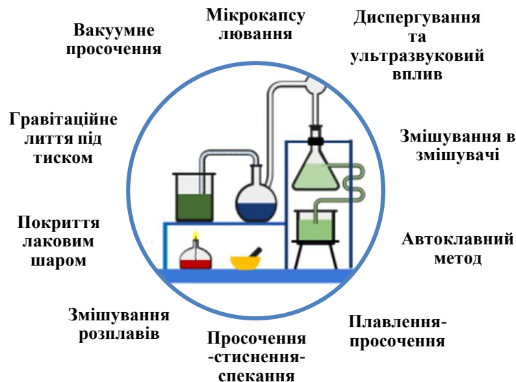
Рисунок 3.2- Основні методи отримання нанопосилених композиційних ТАМ із фазовим переходом
