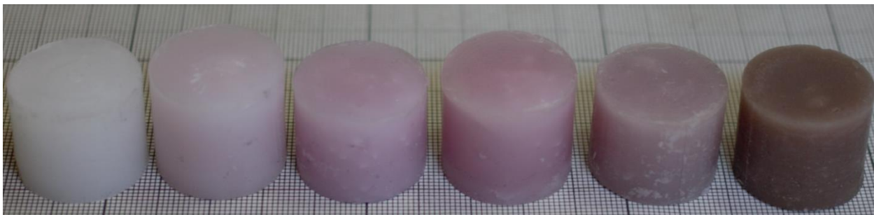
Рисунок 3.14 - Зображення зразків, чистого парафіну (лівий зразок) і парафін/ C_{60} з різним вмістом C_{60} (зліва направо - парафін/ C_{60} 0.006, парафін/ C_{60} 0.012, парафін/ C_{60} 0.020, парафін/ C_{60} 0.024, парафін/ C_{60} 0.052)
