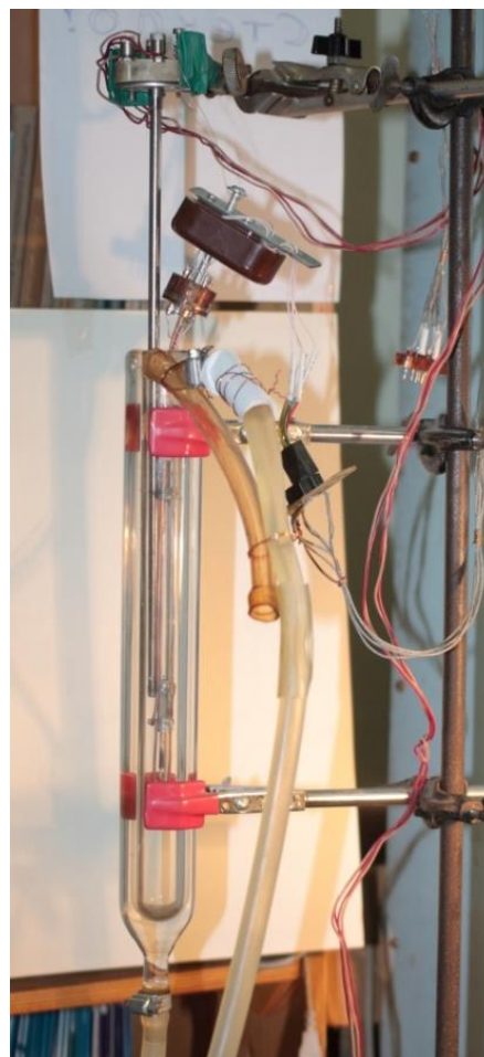
Рисунок 4.18 – Зображення вимірюваного пристрою в скляному рідинному теплообміннику
