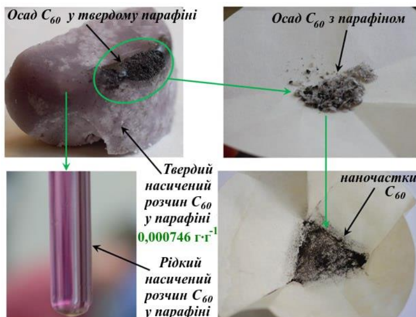
Рисунок 3.13 - Етапи отримання насиченого розчину фулерену C_{60} у парафіні ( 0,000746 \text{ г} \cdot \text{г}^{-1} )
