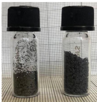
Рисунок 3.6 - Зображення інтеркалірованого (ліворуч) і розширеного (праворуч) графіту.
